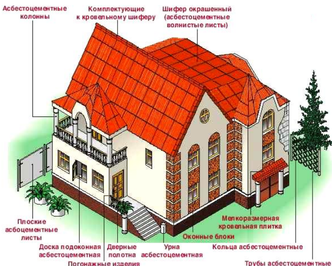
Рис. 7.3. Разновидности изделий из асбестоцемента производимые на заводе ОАО «БелАЦИ» (Белгород)
